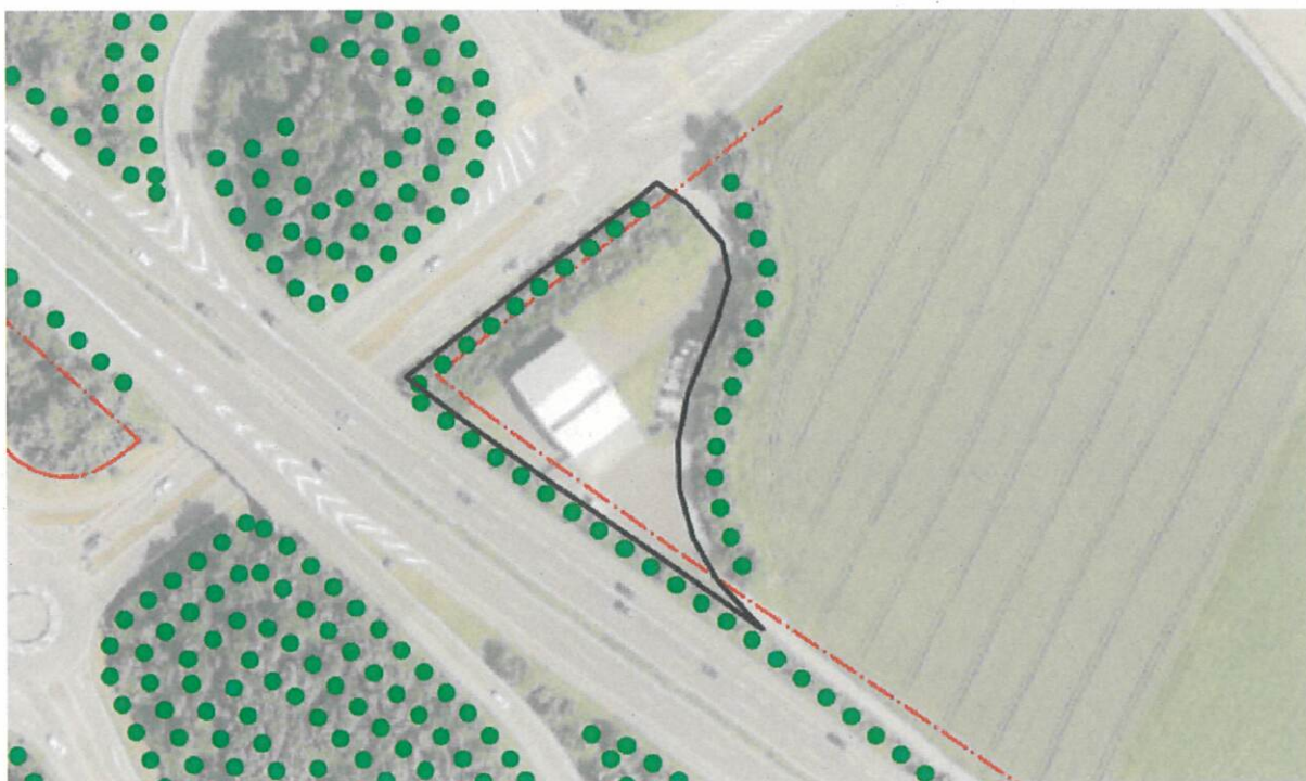
Bestehende Situation Grundstück Nr. 1070: grau umrandet: Parzelle Nr. 1070; rot strichpunktierte: Nationalstrassenbaulinie; grün punktiert; Hecken und Baumhecken
