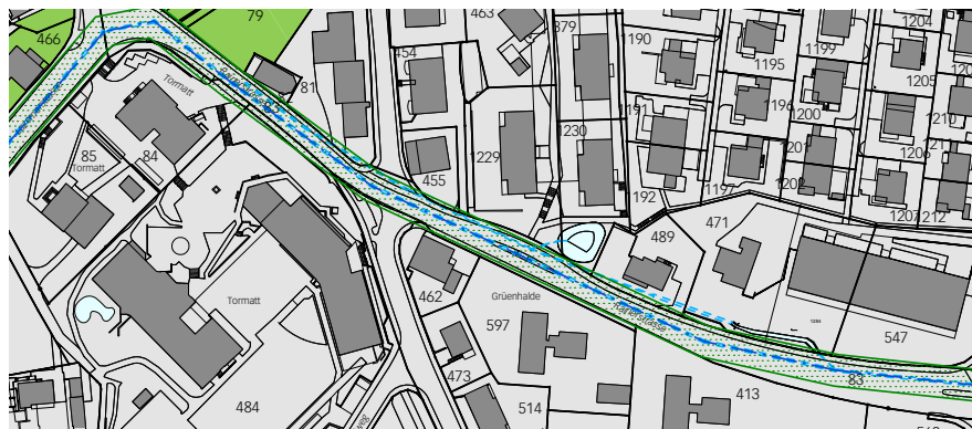
Abb. 1 Planausschnitt «Zonenplan Landschaft»; neuer unterirdischer Gewässerverlauf des Ebersmoosbachs.
